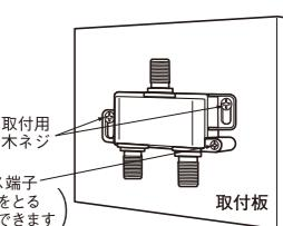
図のように、板壁または収容ボックスの取付板に、付属の取付用木ネジで取り付けてください。
