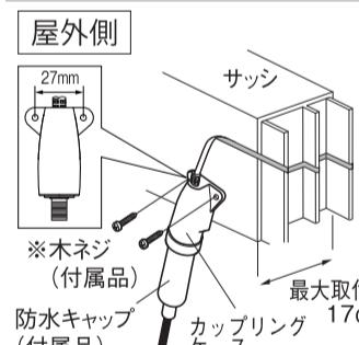
カッピングケースの裏側にある両面テープと木ネジ(付属品)で取り付けができます。
