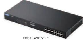
有線ギガビット 1000BASE-T 耐熱50℃ IEEE802.3af/at準拠 国内メーカー コンデンサ2 3年+2年保証 PoE対応
