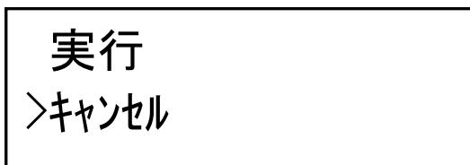
(3) 設定ボタン⑦の「上下」ボタンで、サービスファイルを読み込みするために「実行」を選択します。サービスファイルの読み込みをキャンセルして、画面を元に戻すには「キャンセル」を選択してください。
