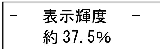
(3) 設定ボタン⑦の「上下」ボタンで蛍光表示管③の表示輝度を変更します。設定モードは下表の通りです。
