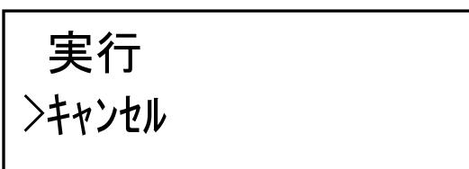
(3) 設定ボタン⑦の「上下」ボタンで、ユニット設定ファイルを読み込みするために「実行」を選択します。ユニット設定ファイルの読み込みをキャンセルして、画面を元に戻すには「キャンセル」を選択してください。
