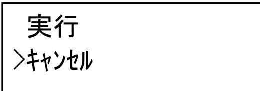
(3) 設定ボタン⑦の「上下」ボタンで、ユニット設定ファイルを作成するために「実行」を選択します。ユニット設定ファイルの作成をキャンセルして、画面を元に戻すには「キャンセル」を選択してください。
