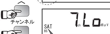
③BSコンバータに電源を供給する場合電源ボタンを2秒以上長押ししてください。アンテナ入力端子からDC15Vが供給中は画面のSAT<sub>BS</sub>の文字が点滅します。(注意) 再度2秒以上長押しすると供給が停止します。
