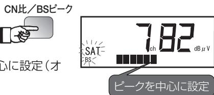
1. CN比/BSピークボタンを押してください。受信レベルのピークがバーグラフの中心に設定(オフセット)されます。
